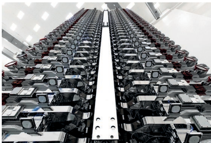
↑ 60 satelitov Starlink 1 naložených pod krytom nosiča Falcon 9.
