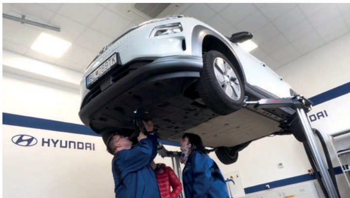
↑ Veľkým zážitkom bolo nahliadnutie pod Hyundai KONA Electric, práve v podlahe je ukrytá 64 kWh batéria.
