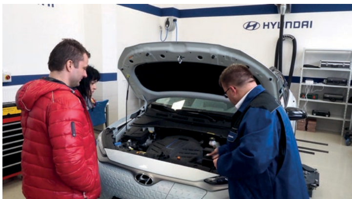
↑ Hyundai KONA Electric má motorový priestor, ako bežné auto. Nájdete tu však výkonný 150 kW elektromotor.
