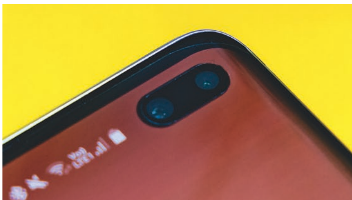
↑ Aj napriek dvom snímačom v displeji na Samsungu Galaxy S10+ vytvoríte fotografiu len prostredníctvom jedného z nich.
