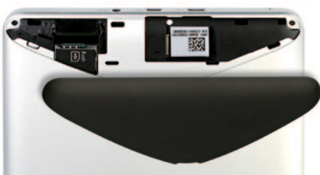
Malý zadný kryt skrýva slot pre microSD a hlavne SIM kartu
