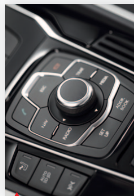
Ovládanie navigačného systému WIP NAV2 a Bluetooth. Škoda, že tu nie je integrované aj podrobnejšie nastavenie multimédií (nastavenia zvuku, ladenie rádii...)
