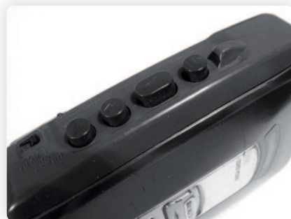
Tlačidlá ovládania prehrávania a posuvný volič FM/AM rádia a kazety
